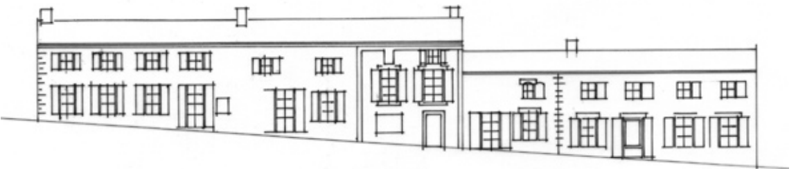
Alignement des façades suivant la pente du terrain à Boisrond (Moragne)
